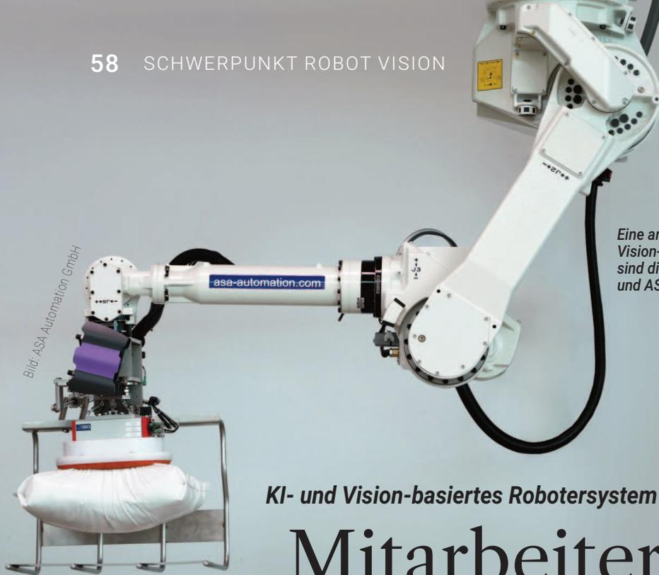
Eine am Roboterarm installierte Kamera, ein KI-basiertes 3D-Vision-System und ein anwendungsspezifischer Sauggreifer sind die wesentlichen Komponenten der von Vision On Line und ASA Automation realisierten 3D-Picking-Lösung.
